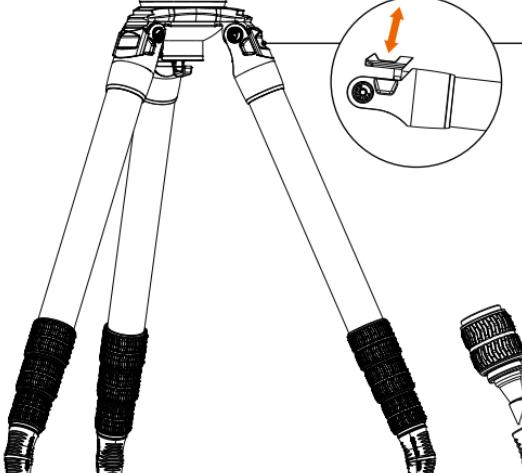
**Bouton de réglage de l'angle:** Tirez sur le bouton pour régler l'angle du trépied. Trois angles différents peuvent être utilisés.
