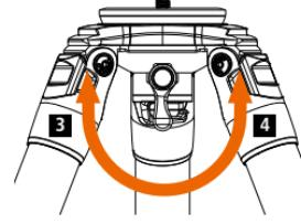
**Bouton de réglage de l'angle:** Si le trépied est utilisé sur un sol inégal, desserrez le bouton de verrouillage de la base, se référer au niveau à bulle et régler la tête jusqu'à ce qu'elle soit égale. Ensuite, verrouillez à nouveau le bouton.
