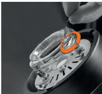
Abb. 1: Wickeln Sie den verdrehten Zünddraht von der Blitzröhrenhalterung ab und ziehen Sie die Blitzröhre vorsichtig aus dem Gerät.
