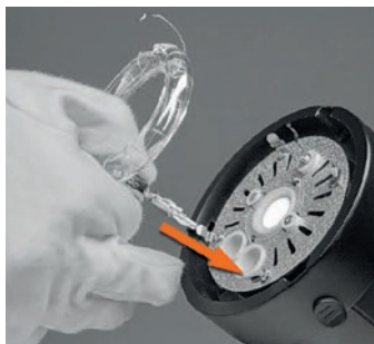
Abb. 2: Um eine neue Blitzröhre einzusetzen, stützen Sie die Beine der Blitzröhre und schieben Sie die Blitzröhre vorsichtig in die Endposition. Wickeln Sie anschließend den Zünddraht wieder um die Blitzröhrenhalterung.
