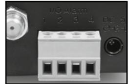
An den Alarmausgang (1 und 2) kann ein externes Gerät wie ein Alarmgeber, eine Sirene oder ein Türöffner angeschlossen werden. Hier wird ein Signal ausgegeben, sobald der digitale Ausgang manuell eingeschaltet wurde, oder wenn der digitale Ausgang für Alarmmeldungen ausgewählt wurde und die Überwachungskamera einen Alarm erkennt.
