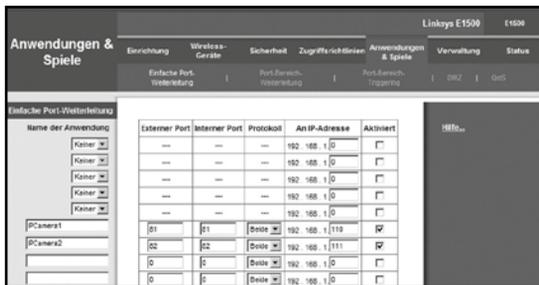
Im dargestellten Beispiel sind am Router zwei Überwachungskameras angeschlossen, eine Kamera mit der Bezeichnung *IPCamera1* und der lokalen Netzwerkadresse 192.168.1.110, eine zweite Kamera mit der Bezeichnung *IPCamera2* und der lokalen Netzwerkadresse 192.168.1.111.
