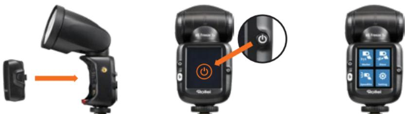
1. Der Akku wird entlang des Positionierungsschlitzes in den Rumpf eingesetzt, wie durch den Pfeil angezeigt.
