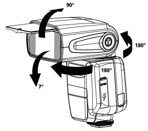
Il lampeggiatore può essere ruotato fino a 90° verso l'alto e fino a 7° verso il basso. È inoltre possibile una rotazione orizzontale di 180° da "sinistra a destra" e da "destra a sinistra". Ruotare il flash verso il soffitto o la parete può far sembrare le immagini più naturali.
