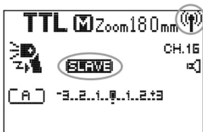
Dans ce mode, le flash peut recevoir des signaux de Canon et Nikon TTL Master light [Flash principal]. Il peut s'allumer bien qu'il ne soit pas attaché à l'appareil photo. Avant de faire une prise de vue, régler l'unité à la même fréquence que l'émetteur. Appuyez sur le bouton zoom à plusieurs reprises sur l'unité esclave jusqu'à ce que le canal ou le groupe soient mis en surbrillance et définissez les valeurs.
