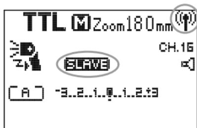
In diesem Modus kann das Blitzlicht Signale vom Canon- und Nikon TTL-Masterlicht empfangen. Es kann blitzen, obwohl es nicht an der Kamera befestigt ist. Stellen Sie vor der Aufnahme das Gerät auf die gleiche Frequenz wie die der Steuereinheit (Senders) ein. Drücken Sie mehrmals hintereinander die Zoom-Taste an der Slave-Einheit, bis der Kanal oder die Gruppe markiert ist und stellen Sie die gewünschten Werte ein.
