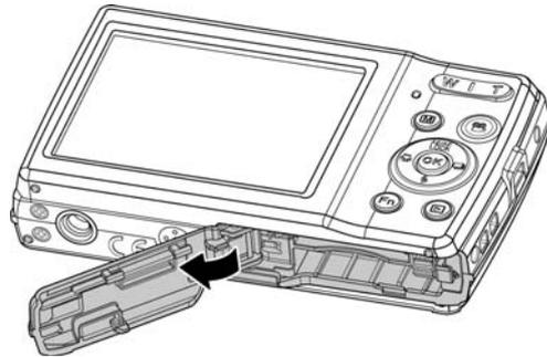
2. Legen Sie den Akku mit dem Kontakt in die Kamera zeigend in der korrekten Ausrichtung in das Fach ein.
