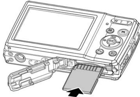
**HINWEIS:** Um die SD/SDHC/SDXC-Karte zu entfernen: Drücken Sie leicht auf die Karte, bis sie herauspringt. Ziehen Sie die Karte heraus und verriegeln Sie das Akkufach.
