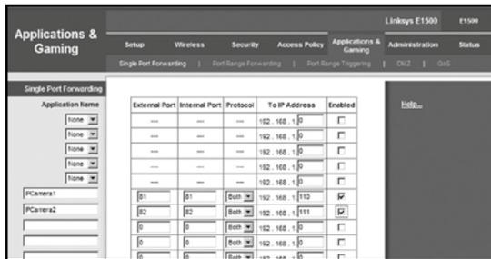
En la imagen de ejemplo hay dos cámaras de vigilancia conectadas al router, una con el nombre *IPCamera1* y la dirección de red local 192.168.1.110, y otra con el nombre *IPCamera2* y la dirección de red local 192.168.1.111.
