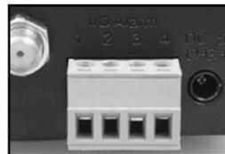
En la salida de alarma (1 y 2) se puede conectar un aparato externo como un emisor de alarma, una sirena o un abrepuertas. Se emite una señal en cuanto la salida digital se activa manualmente o cuando se ha seleccionado la salida digital de avisos de alarma y la cámara de vigilancia detecta una alarma.
